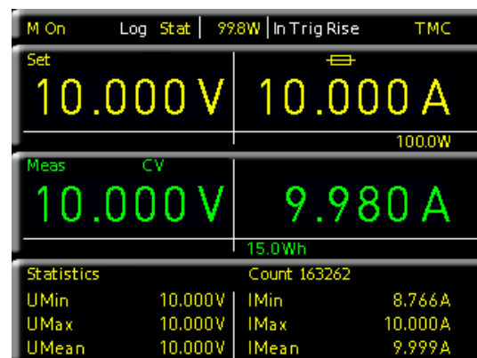
Fig. 4.1 Display values R&S®HMC8041
