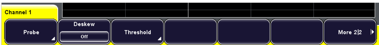
図 5-2: メニュー画面の例: 「Probe」、「Threshold」には下位メニューがあります。「More」でメニューのページを切り替えます。
