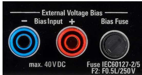
後儀錶板上的外部偏置電壓連接埠
