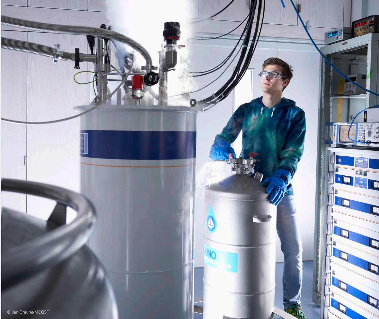
Bild 2: Supraleitende Schaltkreise arbeiten nahe am Temperaturnullpunkt und werden dafür in Kryostaten wie diesem betrieben.
