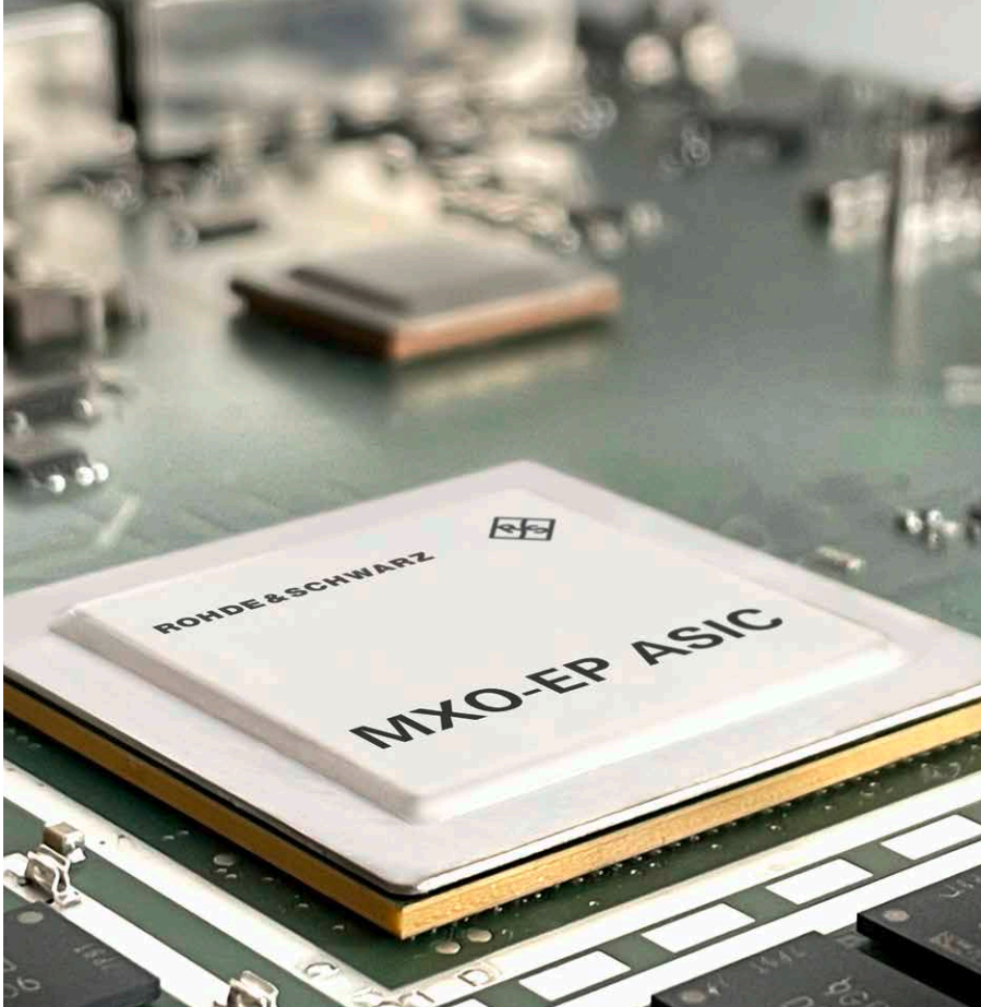
Bild 3: Blick in das Innenleben des R&S®MXO 4: Für die Signalverarbeitung wurde ein neuer 200-Gbit/s-ASIC entwickelt.
