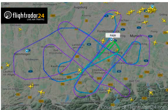
Die Route des ersten MICONAV-Testflugs führte über vier eigens für das Projekt errichtete LDACS-Bodenstationen in Südbayern. Zwei davon sind reine Sender zum Erheben von Navigationsdaten, die anderen beiden sind Transceiver für digitale Flugfunkdaten. Die Flugrouten wurden so geplant, dass der Funkzellenwechsel (Handover) getestet werden konnte (unten links) und außerdem verschiedene Triangulationsszenarien mit zwei bis vier Bodenstationen (unten rechts).
