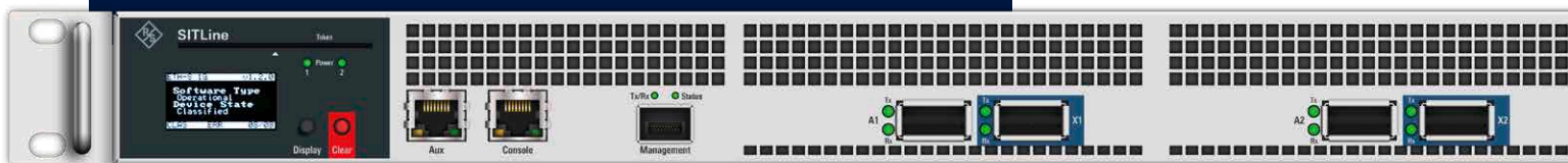
Bild 5: Der R&S®SITLine ETH-XL Ethernet-Verschlüsseler ist QKD-ready.
