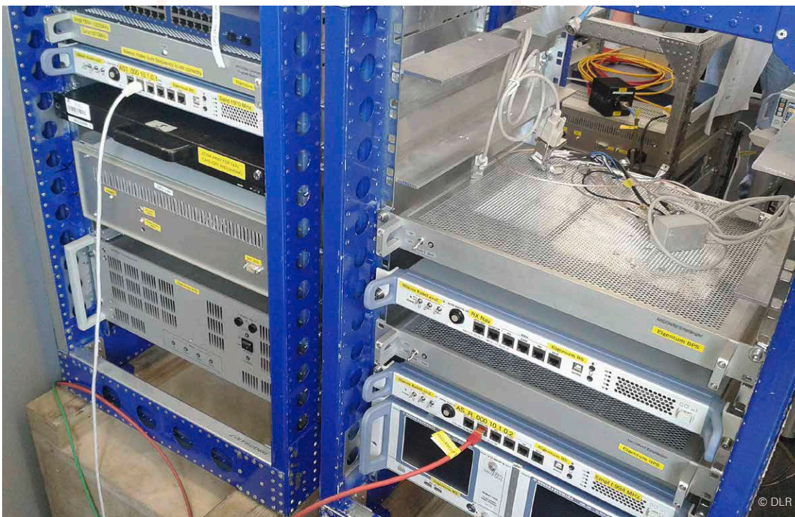
Testflüge 2019: Wellenformentwicklungs- und Messgeräte von Rohde & Schwarz ermöglichten die Funkverbindungen und zeichneten sämtliche erhobenen Daten auf – insgesamt über zwölf Terabyte.
