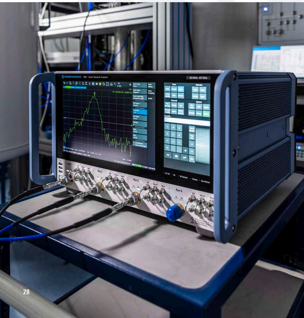
Bild 3: Messaufbau am Walther-Meißner-Institut mit Kryostat (rechts) und einem R&S®ZNA Vektornetzwerkanalysator (links) zur Analyse der Resonanzen supraleitender Schaltkreise.
