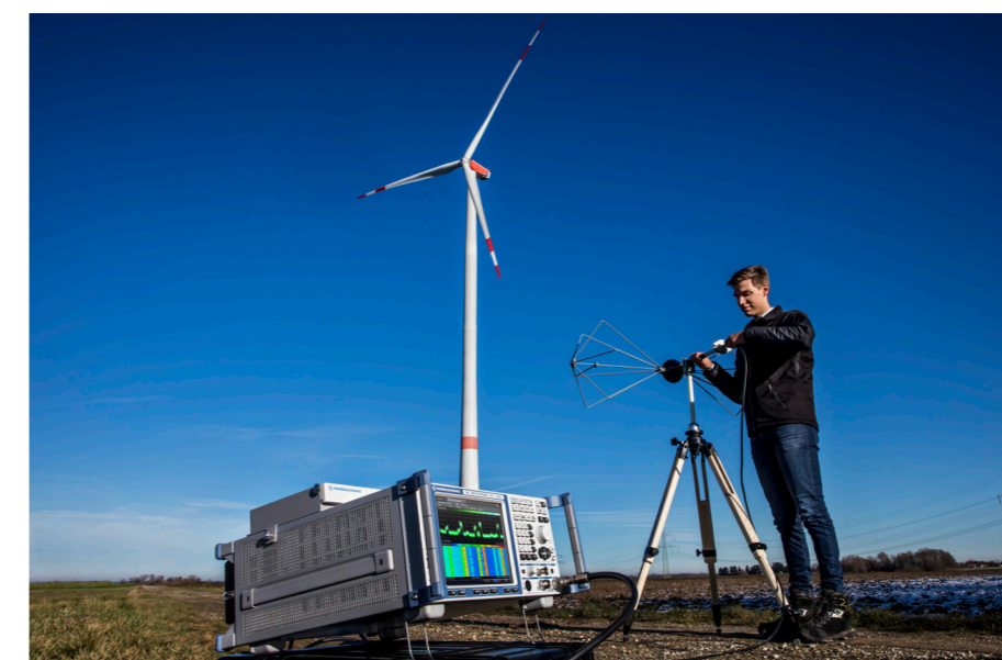
使用电池供电型R&S®ESR进行现场测量。
