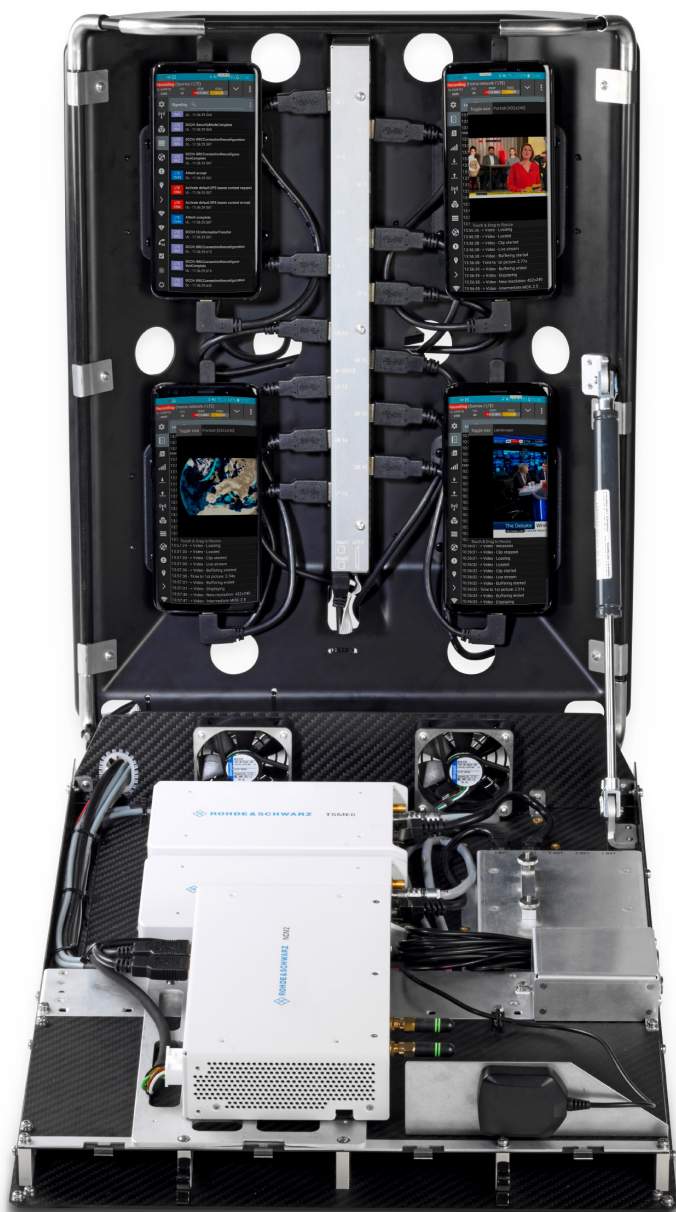
Vue intérieure avec un QualiPoc, un PC compact intégré R&S®NCM4 et un scanner de test sur route ultra-compact R&S®TSME6
