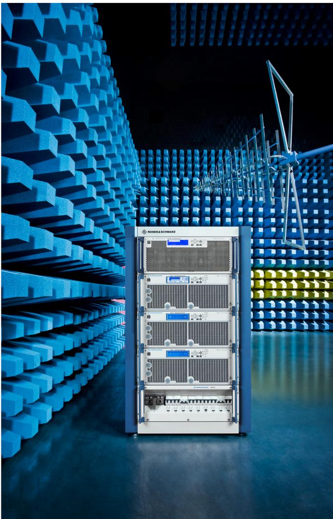
Verstärkersystem bestehend aus 1 × R&S®BBA300 und 3 × R&S®BBA150 im Einsatz bei Störfestigkeitsprüfungen in der EMV von 4 kHz bis 6 GHz.
