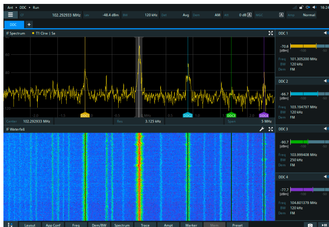
使用4+1个解调信道(不同设置参数)在实时带宽内对多路信号进行同时监测
