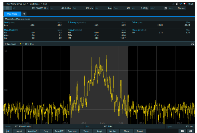
在一个视图中显示符合ITU标准的AM调制深度、FM频率偏移、PM相位偏移测量结果
