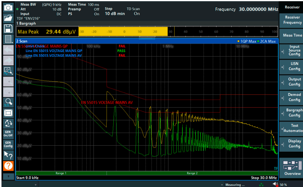
依据EN 55015标准的LED灯自动测量结果。使用准峰值和CISPR平均值检波器在中性线和火线测量整个CISPR频段A和B。使用相关限值线评估测量结果。结果表示为合格/不合格。测量可一键启动，总时间仅为13秒左右(每个频率段和电源线的测量时间为1秒，再加上所需的稳定时间)。
