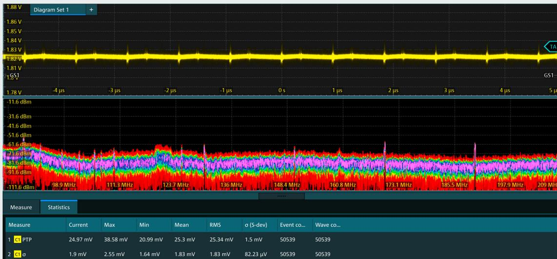
结合使用频谱分析和时间门控，能够有效查找出造成电源路径噪声的耦合源。
