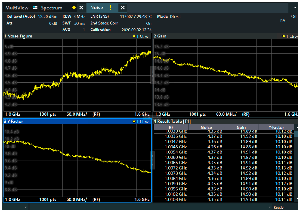
Visualisation simultanée des graphiques relatifs au facteur de bruit, au gain et au facteur Y par rapport à la fréquence et d'un tableau de résultats au format numérique
