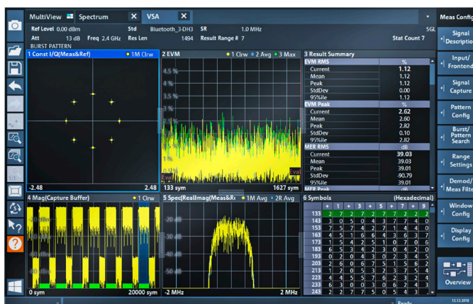
Démodulation d'un signal Bluetooth® avec l'option R&S®FPL1-K70
