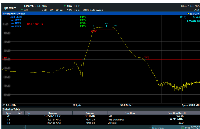
Mesure et qualification d'un filtre SAW (bande passante n-dB, facteur de qualité)
