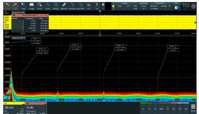
자동 피크 리스트 측정을 통한 하모닉 및 혼변조 분석
