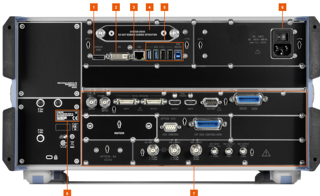
図 5-4: R&S FSMR3 のリアパネル図
