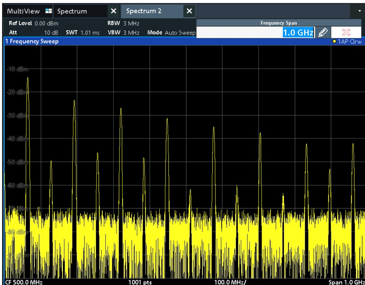
図 6-6: スパンを拡大した校正信号の周波数スペクトラム
