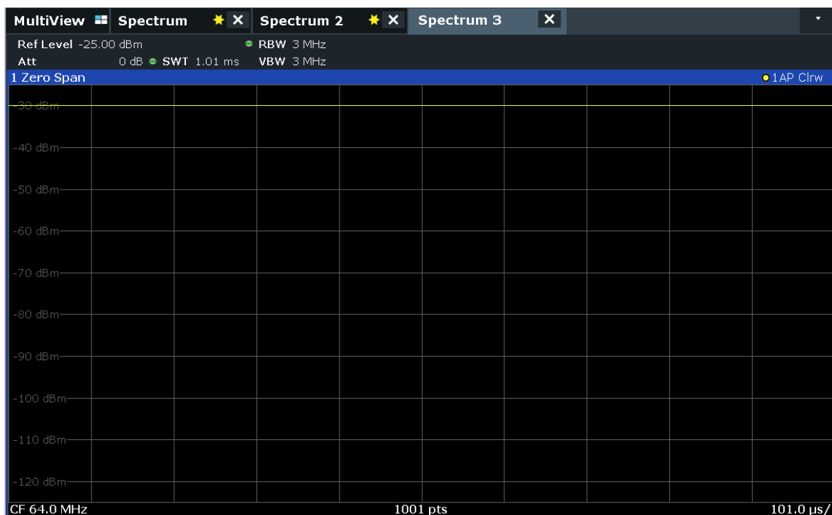
Figura 6-7: Visualizzazione nel dominio del tempo del segnale di calibrazione
