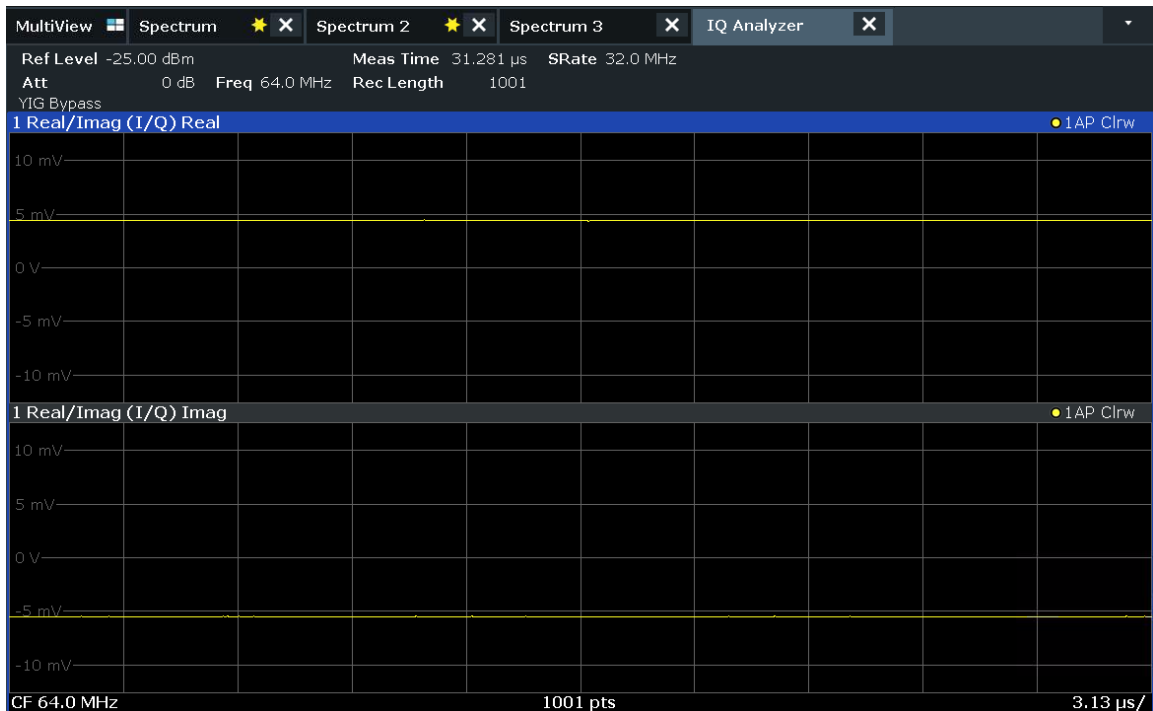
図 6-8: I/Q 解析用 Real/Imag ダイアグラム
