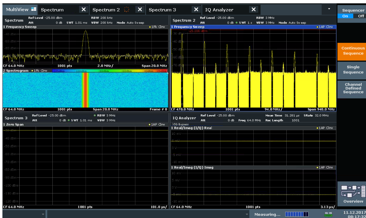
Рис. 6-10: Вкладка "MultiView" с включенной функцией генератора последовательностей Sequencer
