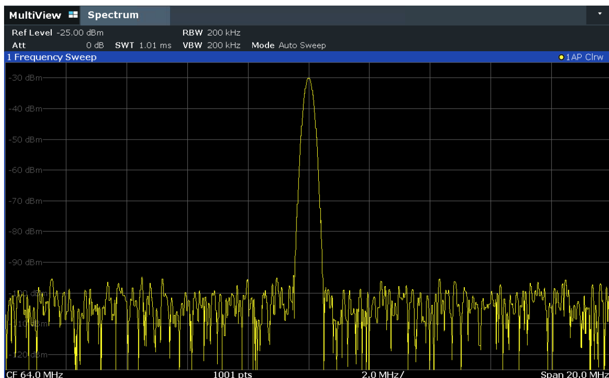
Рис. 6-2: Калибровочный сигнал с оптимизированными настройками отображения
