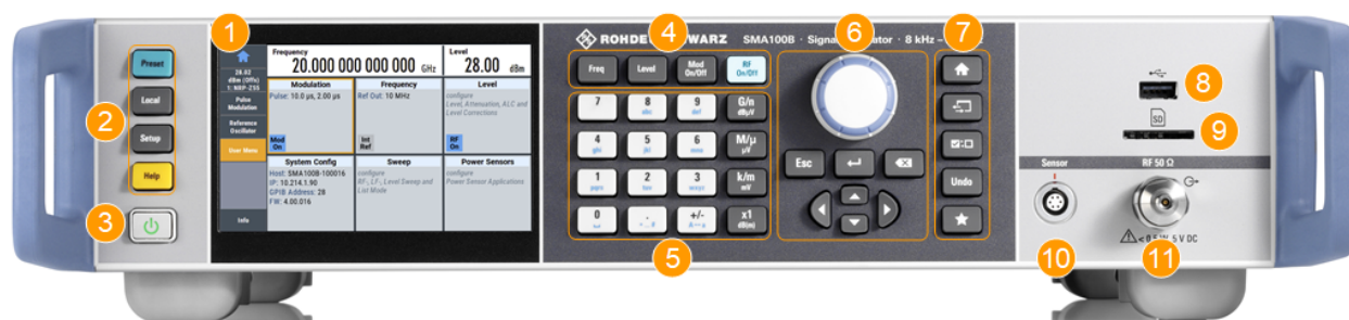
図 5-1: 高さ 2HU の R&S SMA100BRF 信号発生器のフロントパネルの外観 (オプション R&S SMAB-B92)
