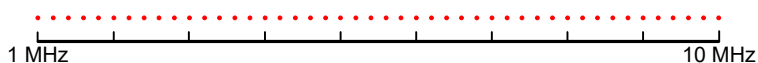
Bild 15-3: Lineare X-Achsen-Skalierung: Der Abstand zwischen den Messpunkten ist gleich, z. B. 200 kHz
