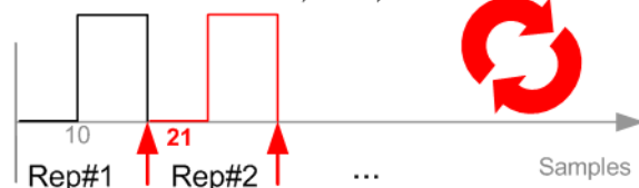
Рис. 4-19: Пример: обработка кривой MARKER TRACE, если контрольная длина CONTROL LENGTH не используется
