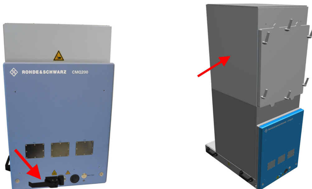
Obr. 4-3: Verze komory s manuálně ovládanými dveřmi (vlevo) a s možným výškovým prodloužením (vpravo)
