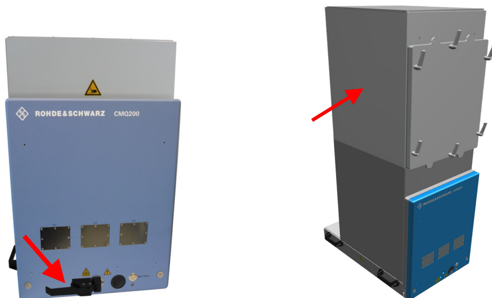
図 4-3: 手動式ドアのあるチャンバー（左）と高さ拡張オプションを取り付けたチャンバー（右）
