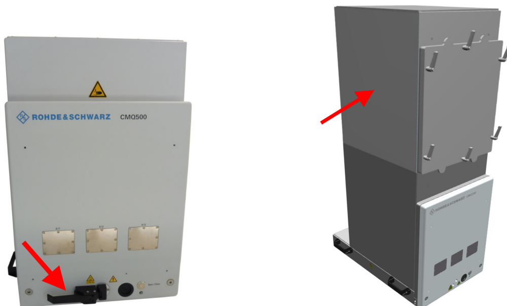
图 4-3: 配有手动门的屏蔽箱 (左) 和配有可选高度扩展件的屏蔽箱 (右)
