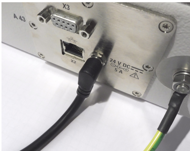
Figura 7-1: Connettore di alimentazione CC 24 V [X1] (al centro)
