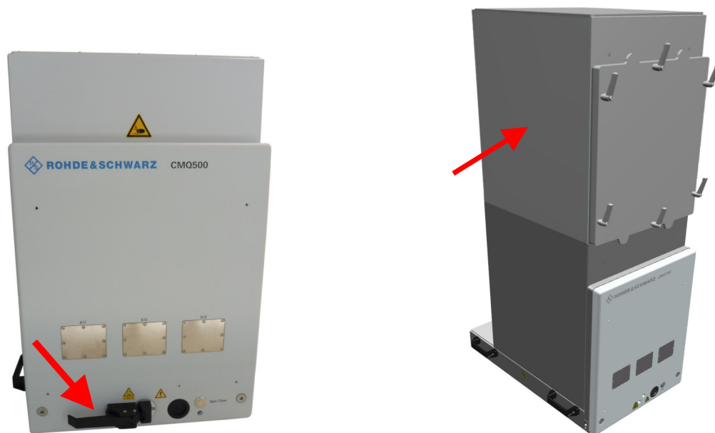
圖 4-3: 配有手動門的屏蔽箱 (左) 和配有高度擴展件選配的屏蔽箱 (右)
