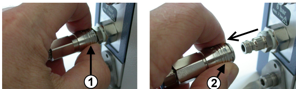
Obr. 11-2: Odpojení přívodu stlačeného vzduchu
