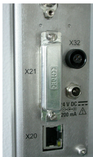
Obr. 6-10: Bezpečnostní kryt konektoru D-Sub 25-pin [X21]
