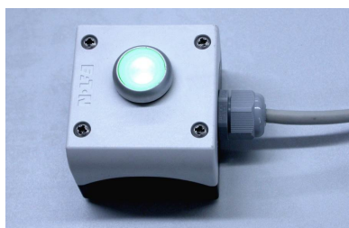
Obr. 7-3: Zelené světlo v tlačítku znamená, že jsou dveře zavřené
