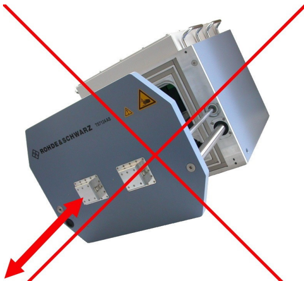
Obr. 5-2: Nezvedejte bez zabezpečených dveří, hrozí riziko nekontrolovaného pohybu dveří
