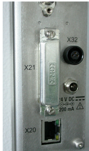
Bild 6-10: Sicherheitskappe, die den D-Sub-25-Pin-Steckverbinder abdeckt [X21]
