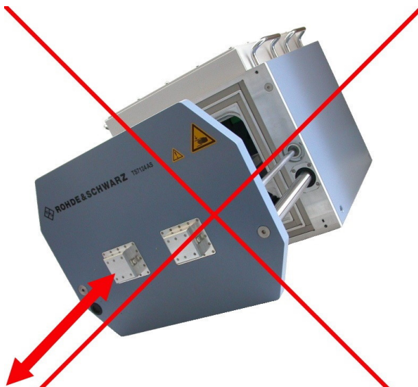
Bild 5-2: Die Schirmkammer nicht mit ungesicherter Tür anheben. Es besteht die Gefahr einer unkontrollierten Türbewegung
