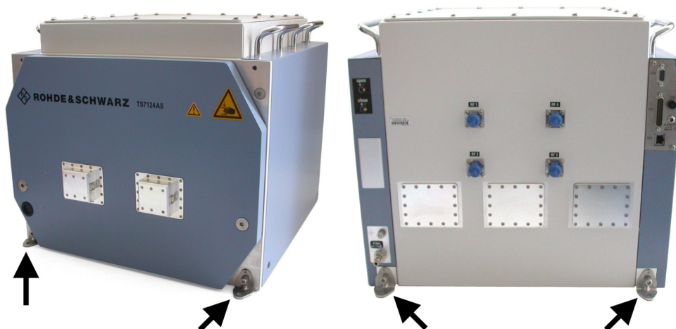
Figura 6-2: Posiciones de las escuadras de montaje para la fijación de la cámara al soporte
