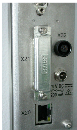
Figura 6-10: Tapa de seguridad, que cubre el conector D-Sub de 25 pines [X21]
