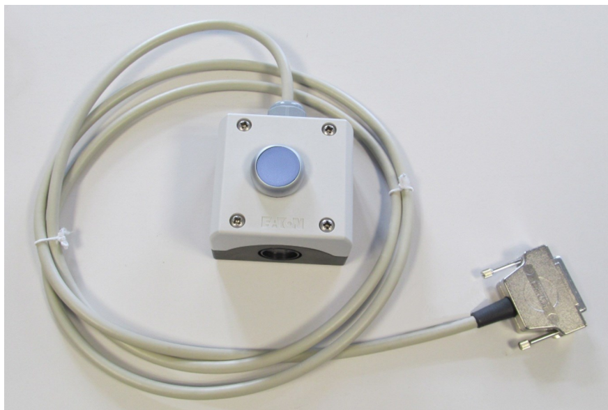
Figura 4-4: Interruptor de botón con cable y conector
