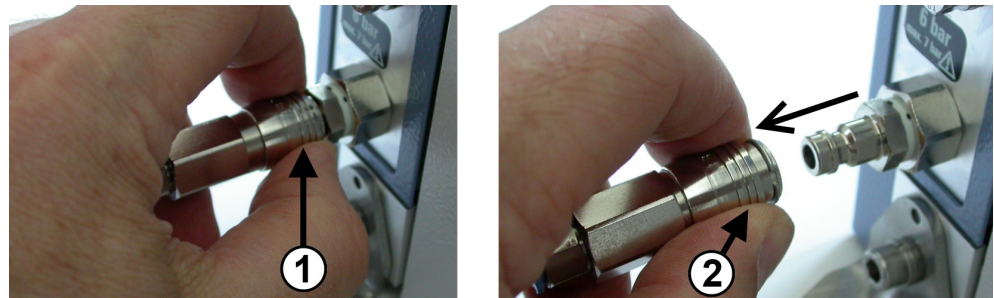
Kuva 11-2: Paineilman syötön irtikytkentä
