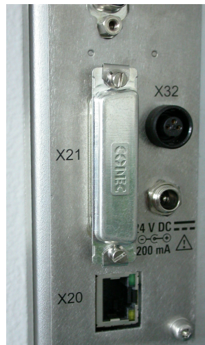
Kuva 6-10: Turvasuojus, joka suojaa D-Sub 25 -nastaliittintä [X21]
