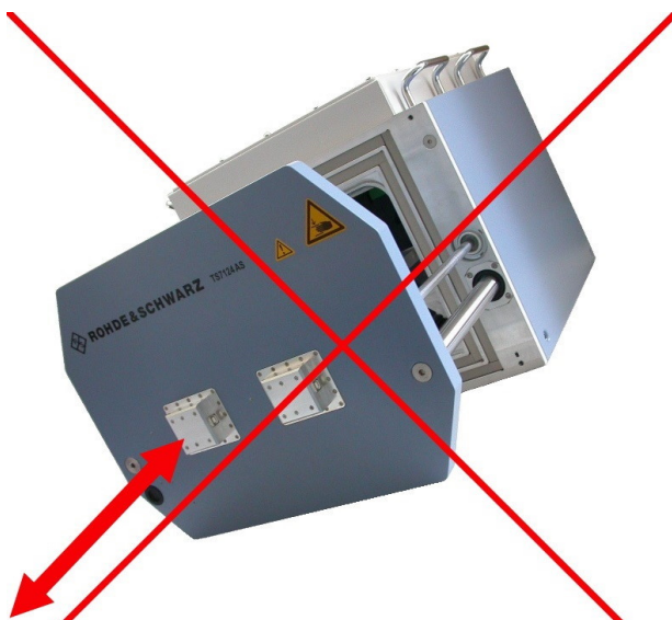
Figure 5-2 : Ne soulevez pas la chambre lorsque la porte n'est pas sécurisée : risque de mouvement incontrôlé de la porte
