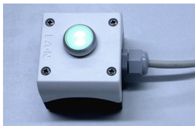
आंकड़े 7-3: बटन में हरा प्रकाश इंगित करता है कि दरवाजा बंद है
