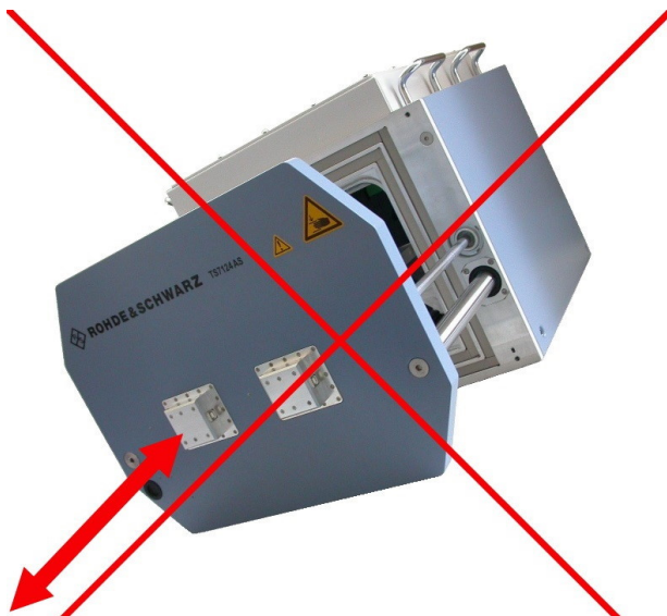
Ábra 5-2: Ne emelje meg rögzítetlen ajtóval: ellenőrizhetetlen ajtómozgás veszélye
