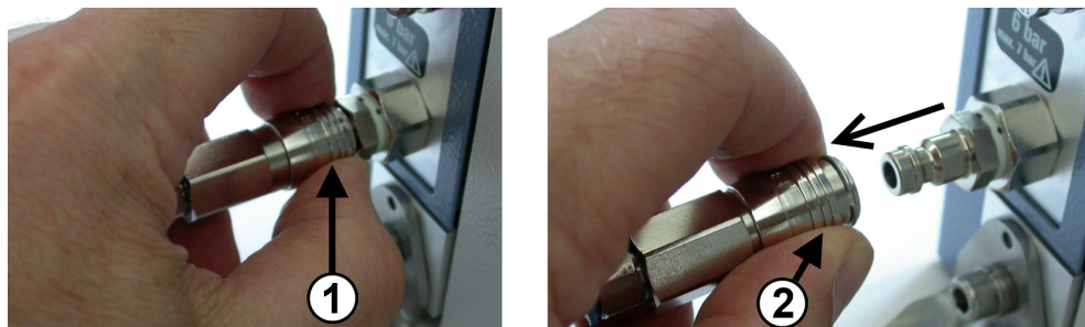
Ábra 11-2: A sűrítettlevegő-ellátás leválasztása
