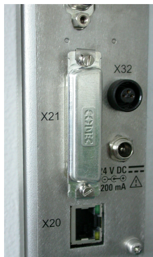
Ábra 6-10: Biztonsági fedél a D-Sub 25 tűs csatlakozón [X21]
