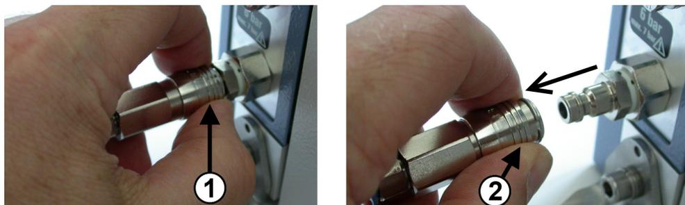
*Figura 11-2: Scollegare l'alimentazione dell'aria compressa*
