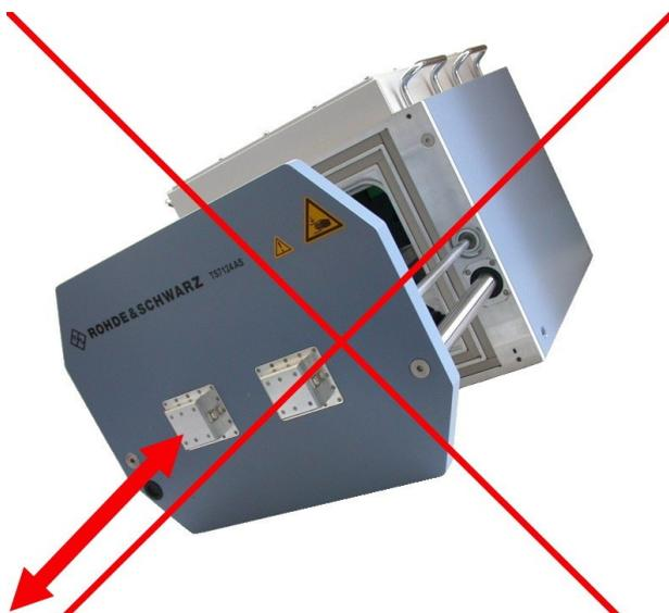
Figura 5-2: Non sollevare con la porta non messa in sicurezza: pericolo di movimenti incontrollati della porta
