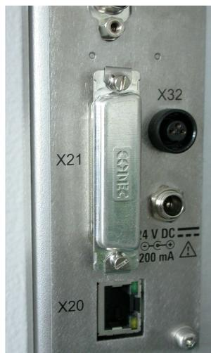
**Figura 6-10: Cappuccio di sicurezza, che copre il connettore D-Sub a 25 pin [X21]**
