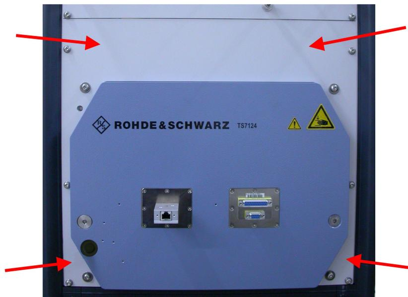
**Figura 6-3: Camera fissata in un rack da 19" con il kit di montaggio a rack**
