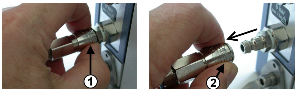
図 11-2: 圧縮空気供給源の取り外し
