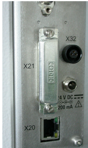
그림 6-10: D-Sub 25핀 커넥터를 덮고 있는 안전 캡 [X21]
