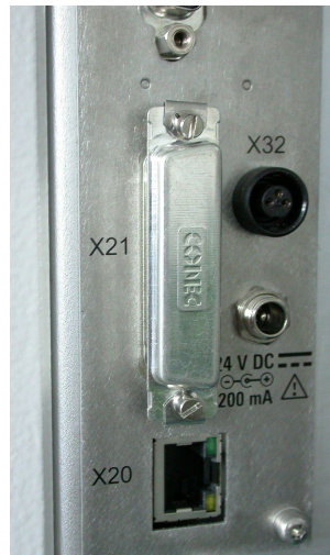
6-10 pav.: Apsauginis gaubtelis ant „D-Sub“ 25 kontaktų jungties [X21]
