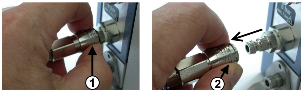
11-2 pav.: Suslėgtojo oro tiekimo sistemos atjungimas
