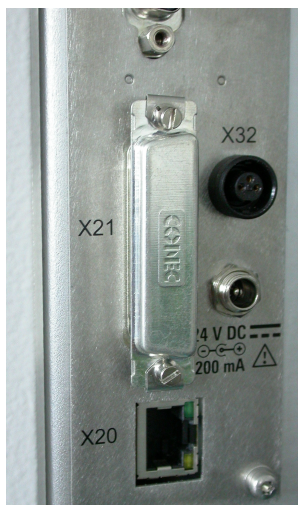
Figură 6-10: Capacul de siguranță, care acoperă conectorul D-Sub cu 25 de pini [X21]
