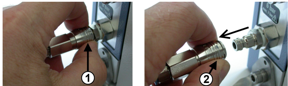
Figură 11-2: Deconectarea sursei de aer comprimat
