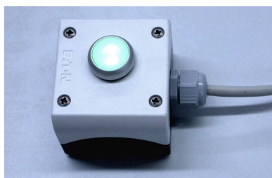
Рис. 7-3: Зеленая подсветка кнопки сигнализирует о закрытом состоянии двери
