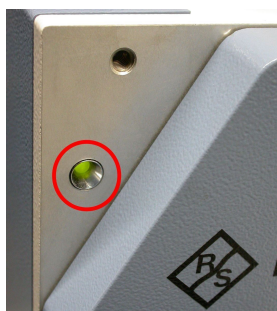
Рис. 7-2: Светодиодный индикатор состояния рядом с дверью
