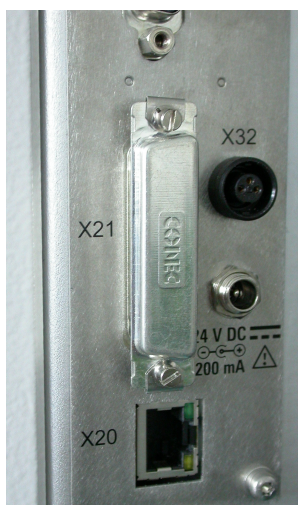
Рис. 6-10: Защитная заглушка на 25-контактном разъеме D-Sub [X21]
