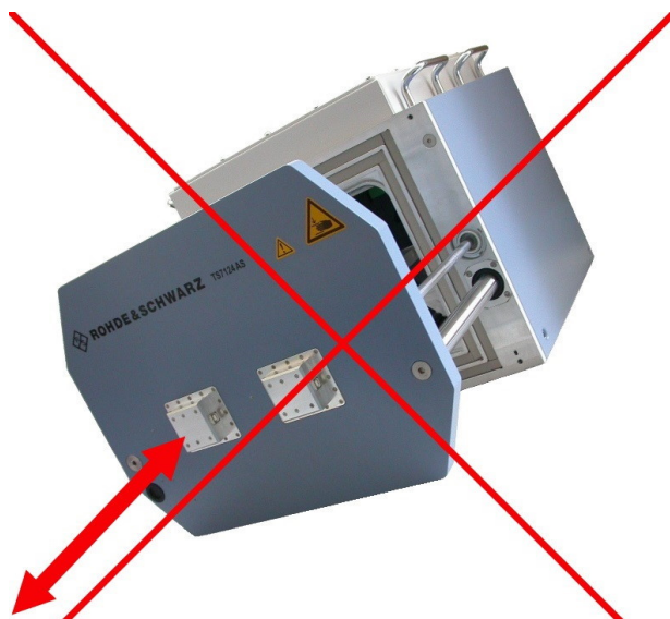
Рис. 5-2: Не поднимать камеру с незафиксированной дверью. Опасность неконтролируемого перемещения двери.
