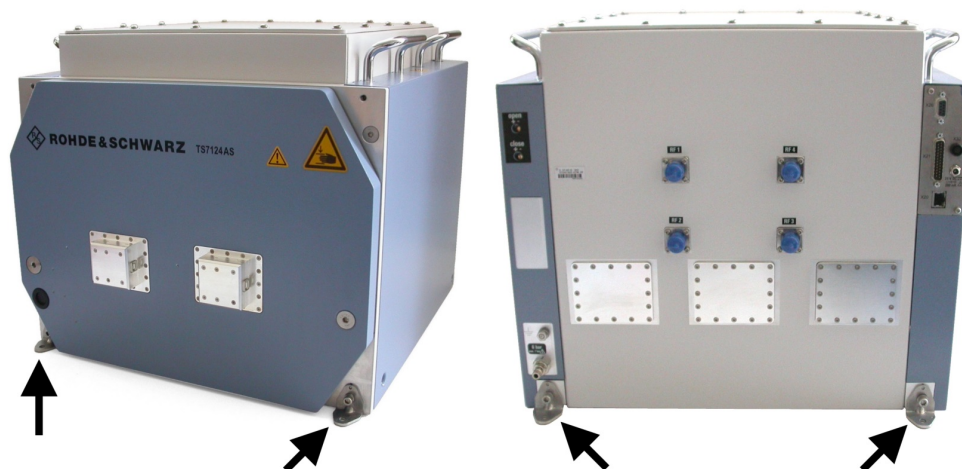
Bild 6-2: Monteringsvinklarnas placering för fixering av kammaren i dess stöd
