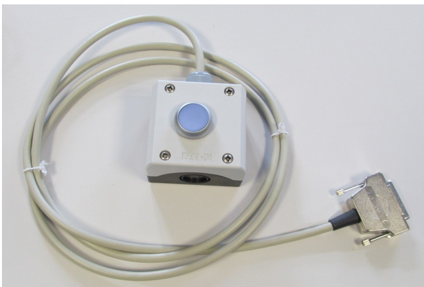
Bild 4-4: Tryckknappsenhet med kabel och kontaktdon
