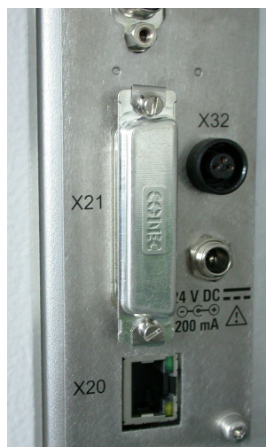
Bild 6-10: Säkerhetslock som täcker D-Sub 25-stiftsuttaget [X21]
