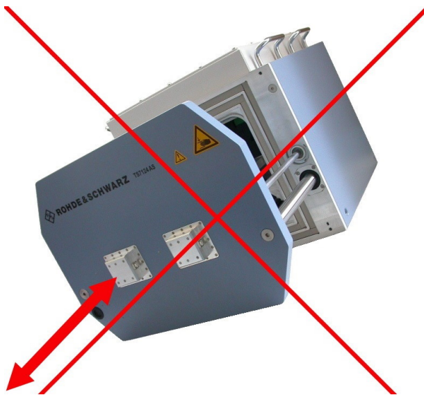
รูป 5-2: อย่ายกเมื่อไม่มีการยึดประตูอย่างแน่นหนา: เสี่ยงต่อการเคลื่อนตัวของประตูที่ไม่มีการควบคุม
