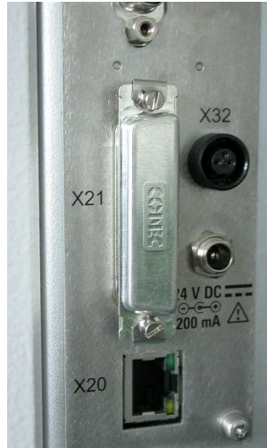
รูป 6-10: ฝาปิดนิรภัย ที่ปิดตัวเชื่อมต่อ D-Sub 25 พิน [X21]
