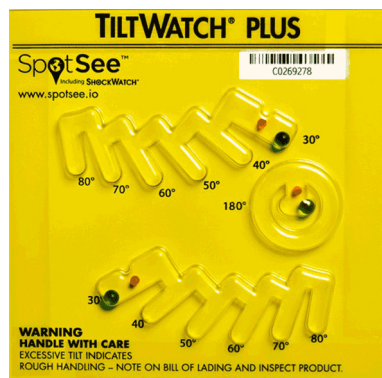
图 6-2: 倾斜指示器：所有玻璃球均在原位，则表示正常
