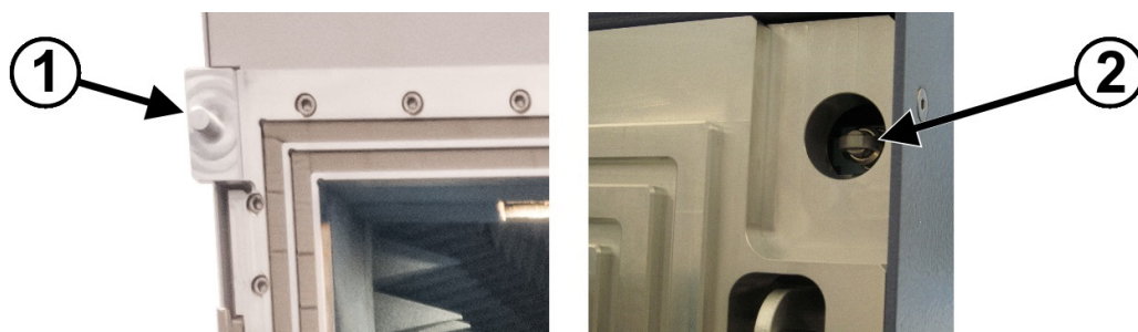
图 4-6: 用于门锁装置的上方互锁键
