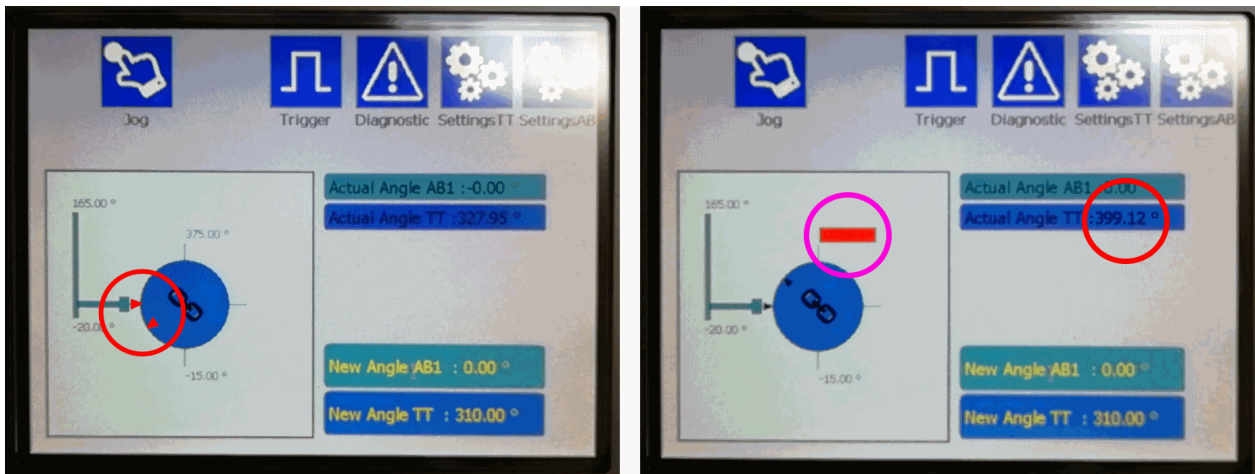
Bild 7-11: Ignorieren Sie während der Referenzierung die roten Pfeile (links) und Drehtischwinkel außerhalb des Bereichs von -15^\circ bis +375^\circ (rechts).
