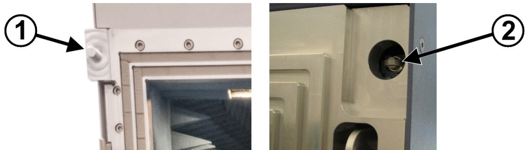
Bild 4-6: Oberer Verriegelungsstift für die Türverriegelung
