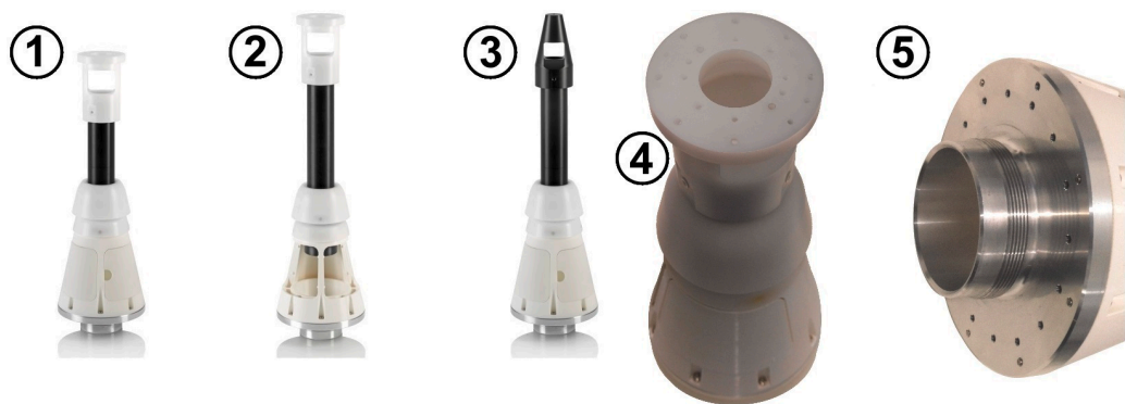
Bild 7-6: Konfigurationsbeispiele für die Teleskopmessobjekthalterung mit verschiedenen Adaptern
