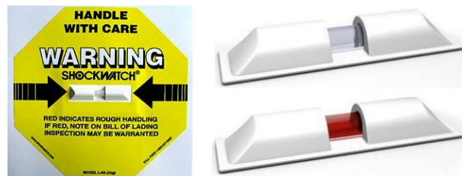
Bild 6-1: Stoßindikator, farblos = OK, rot = Grenzwert überschritten
