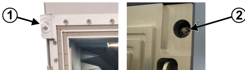
図 4-6: ドアロック機構用の上部インターロックキー
