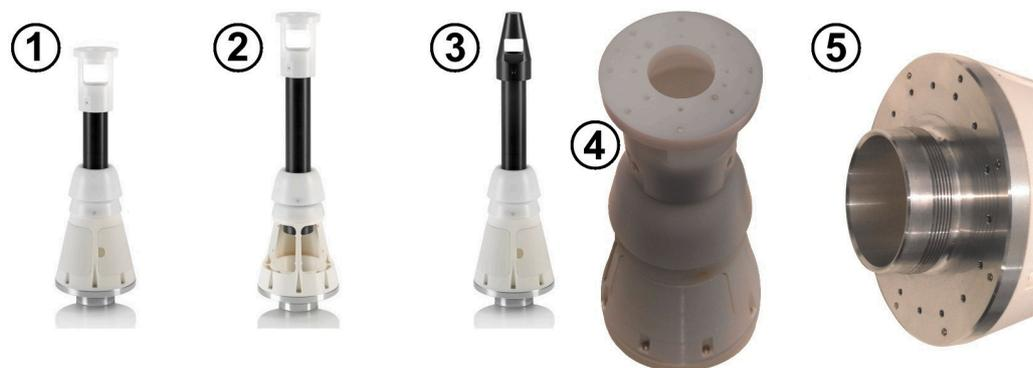
図 7-6: 各種アダプターを使用した伸縮 DUT ホルダーの構成例
