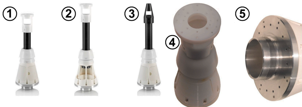
Afbeelding 7-6: Voorbeelden van telescopische DUT-houderconfiguraties met verschillende adapters
