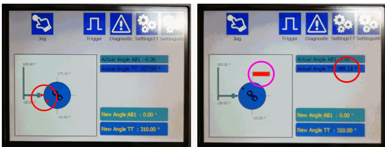
Afbeelding 7-11: Negeer tijdens de referentie-instelling de rode pijlen (links) en draaihoeken buiten het bereik van -15° tot +375° (rechts)
