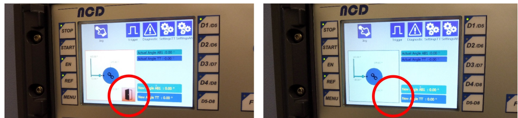
Afbeelding 4-8: Symbool vergrendeling in het display van de positionerbesturing
