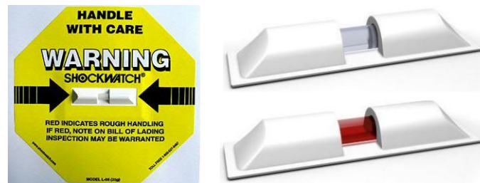
Afbeelding 6-1: Schokindicator, OK indien kleurloos, kapot indien rood
