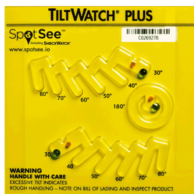
Рис. 6-2: Индикатор наклона, в норме, если шары находятся в исходном положении
