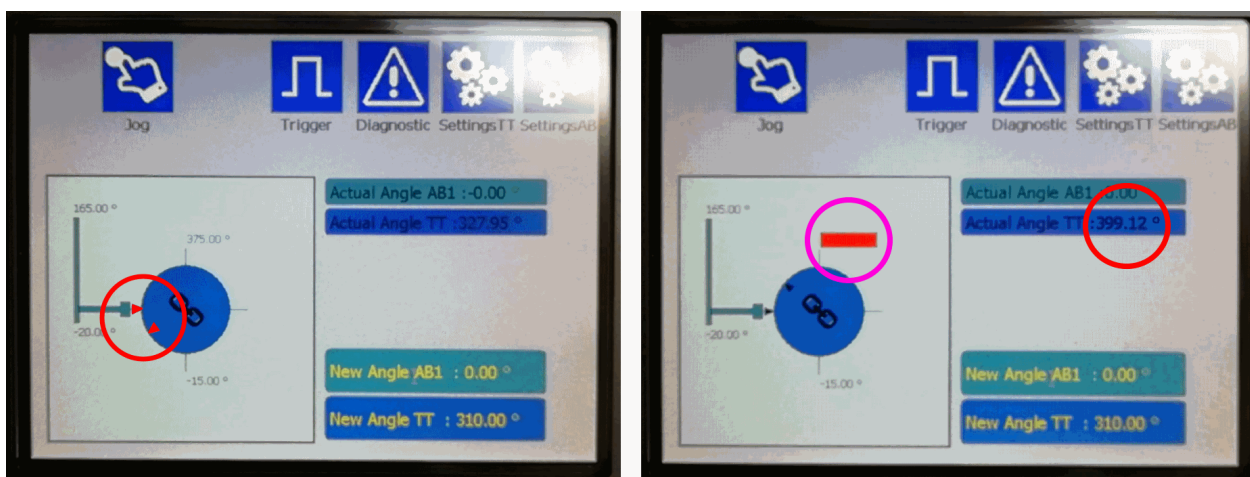
Рис. 7-11: Во время базирования игнорируйте красные стрелки (слева) и углы поворотного стола за пределами диапазона от -15^\circ до +375^\circ (справа)
