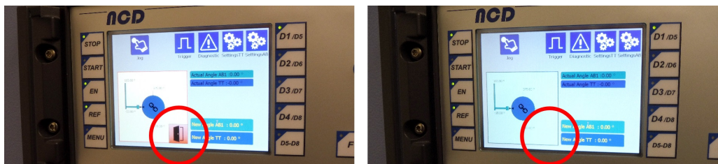
Рис. 4-8: Символ блокировки на дисплее контроллера позиционера
