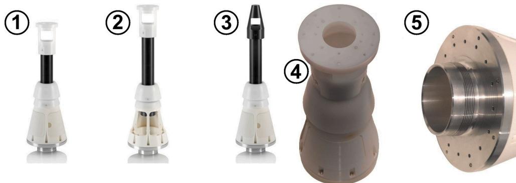
圖 7-6: 含各種轉接器的伸縮 DUT 支架配置示例
