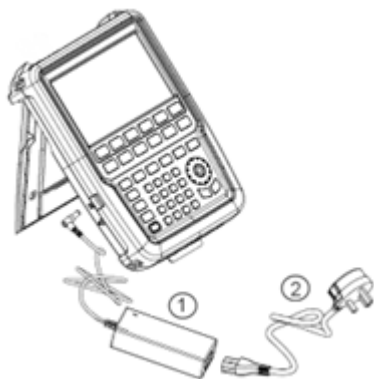
Рис. 3-1: Сетевой адаптер питания
